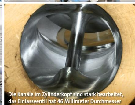
Die Kanäle im Zylinderkopf sind stark bearbeitet, das Einlassventil hat 46 Millimeter Durchmesser
