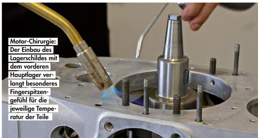
**Motor-Chirurgie:** Der Einbau des Lagerschildes mit dem vorderen Hauptlager verlangt besonderes Fingerspitzengefühl für die jeweilige Temperatur der Teile
