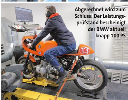
Abgerechnet wird zum Schluss: Der Leistungsprüfstand bescheinigt der BMW aktuell knapp 100 PS
