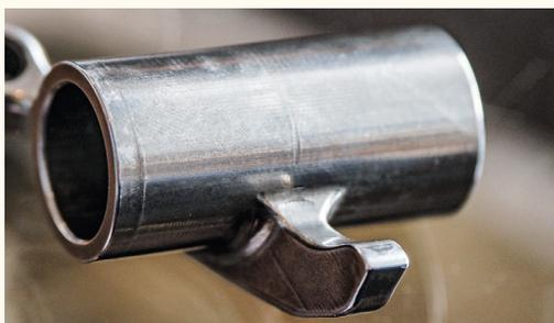
Selbst entwickelte Kipphebel, mangels guter Nadellager mit Gleitlagerschmierung. Besser als original
