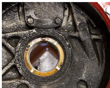
**Die Ursache des Ölverlusts: Der Simmerring am Hauptlager und der Ölpumpendeckel**
