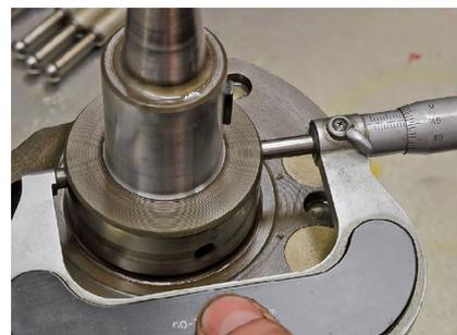
**Mikrometerweise:** Entscheidend für die weitere Bearbeitung ist das Messergebnis der Lagerzapfen von Haupt- und Pleuellager
