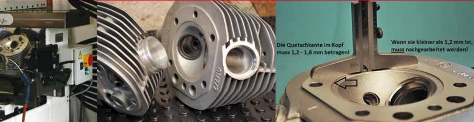
Keile eingesetzt, dazu kommen Ansaugstutzen für DellOrto- oder Bing-Vergaser. Doppelzündungsgewinde M 14, Doppelventilfeder Racing für Ventilhuben bis 14 mm.
