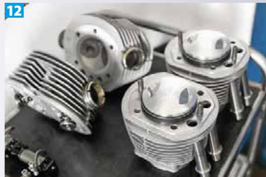
**12 Einbau:** die bearbeiteten Zylinder und Köpfe, mitsamt Schmiedekolben einbaufertig
