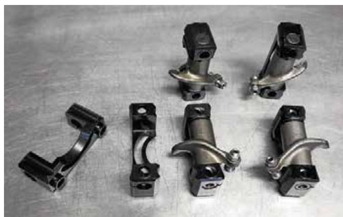
Eigens konstruiert wurden Kipphebelböcke ohne Axialspiel und leichtere Kipphebel für bessere Drehzahlfestigkeit
