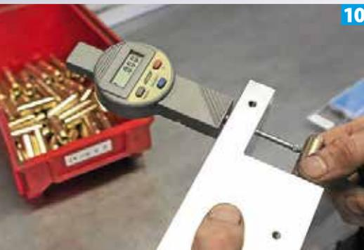
**10 Messen:** Höchste Präzision gilt auch bei den eigens gefertigten Ventilführungen
