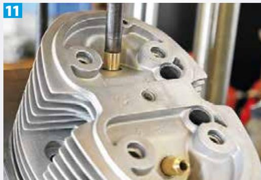
**11 Pressen:** nach einem Bad in flüssigem Stickstoff werden die Ventilführungen eingepresst
